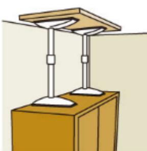
【天井突っ張り固定】
